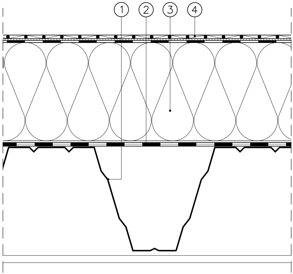
Maßstab 1:2.5 (Die für die Abdichtung relevanten Schichten sind überhöht dargestellt!)
