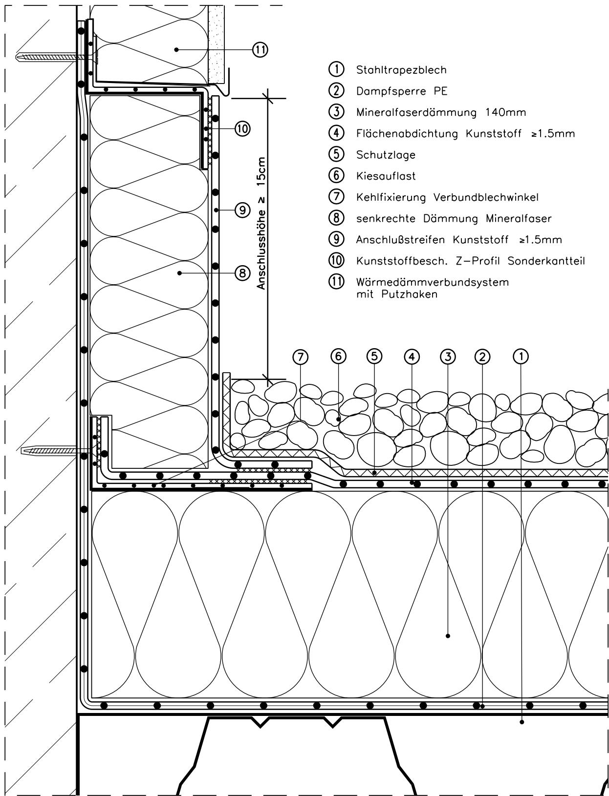
Maßstab 1:2.5 (Die für die Abdichtung relevanten Schichten sind überhöht dargestellt!)
